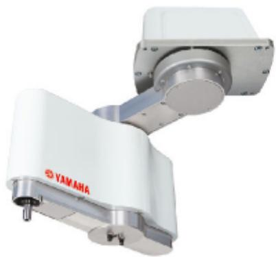
机器人运动轴工业机器人在生产中，一般需要配备除了自身性能特点的设备，如转动工件的回转台，移动工件的移动台等。这些设备的运动和位置控制都需要与工业机器人相配合并要求相应精度。通常机器人运动轴按其功能可划分为机器人轴、基座轴和工装轴，基座轴和工装轴统称外部轴。机器人轴是指操作本体的轴，属于机器人本身，目前商用的工业机器人大多以8轴为主。基座轴是使机器人移动轴的总称，主要指行走轴（移动滑台或导轨）。工装轴是除机器人轴、基座轴以外轴的总称，指使工件、工装夹具翻转和回转的轴，如回转台、翻转台等。实际生产中常用的是6关节工业机器人，该操作机有6个可活动的关节（轴）。附表与图1为常见工业机器人本体运动轴的定义，值得注意的是，不同的工业机器人本体运动轴的定义也不同。用于保证末端执行器达到工作空间任意位置的轴称为基本轴或主轴；用于实现末端执行器任意空间姿态的轴，称为腕部轴或次工业轴。买东佑达直线电机就找上海裕飞！喷涂机器人保养
